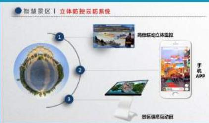
高新兴推出的立体防控云防系统，改变传统监控方式。系统通过高点摄像机的鸟瞰视角掌握监控区域整体情况，通过标签视频联动技术调用低点摄像机从不同角度查看监控区域细节，能大大改善监控体验、指挥效率，摆脱以往基于二维电子地图查看视频不够直观的束缚。系统可与景区已建信息系统进行对接，监控人员不再需要单独到每个系统上查看相关信息，所有重要信息都能在当前全局监控画面直观展示，极大地提高了工作效率，形成纵览全局和掌控细节相结合的全方位立体化综合防控系统，大大提高日常安全管理的效率，保障游客安全。
